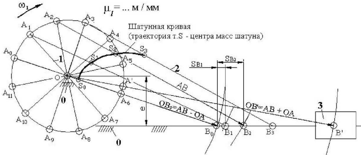
Рис. 2.6. Определение крайних положений механизма и построение разметки
