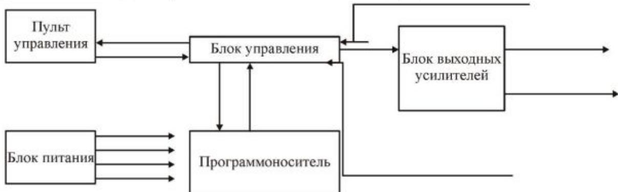
Рис. 12.1. Состав устройства ЭЦПУ-6030
