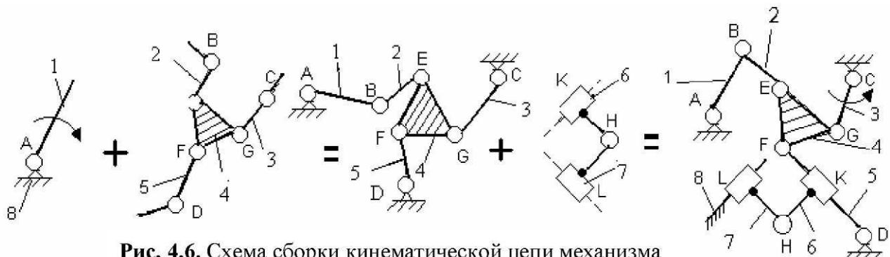
Рис. 4.6. Схема сборки кинематической цепи механизма
