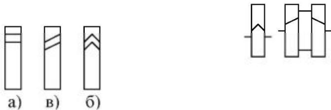
Рис. 4.7. Шевронная передача б)
