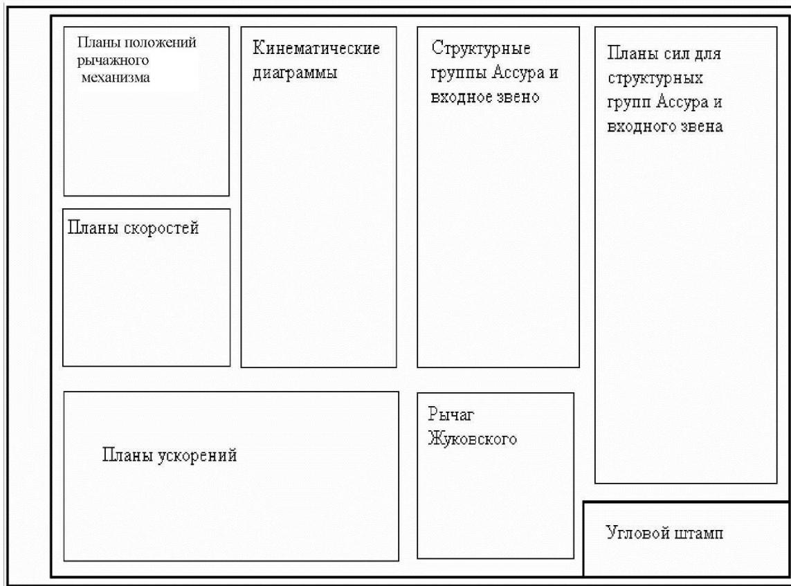
Рис. 2.5. Расположение графического материала на втором листе
