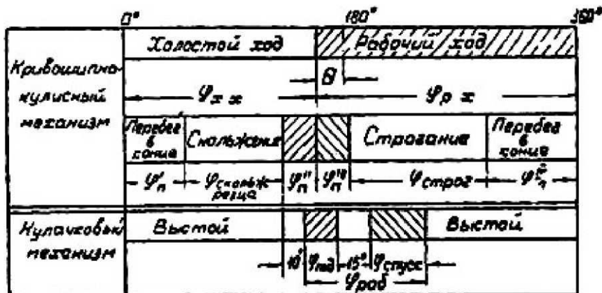
Рис. 4.3. Циклограмма работы механизмов строгального станка
