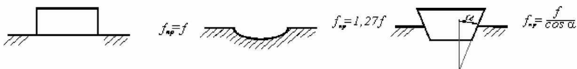
Рис. 7.2. Конструкции поступательной кинематической пары и приведенный коэффициент трения f_{np}
