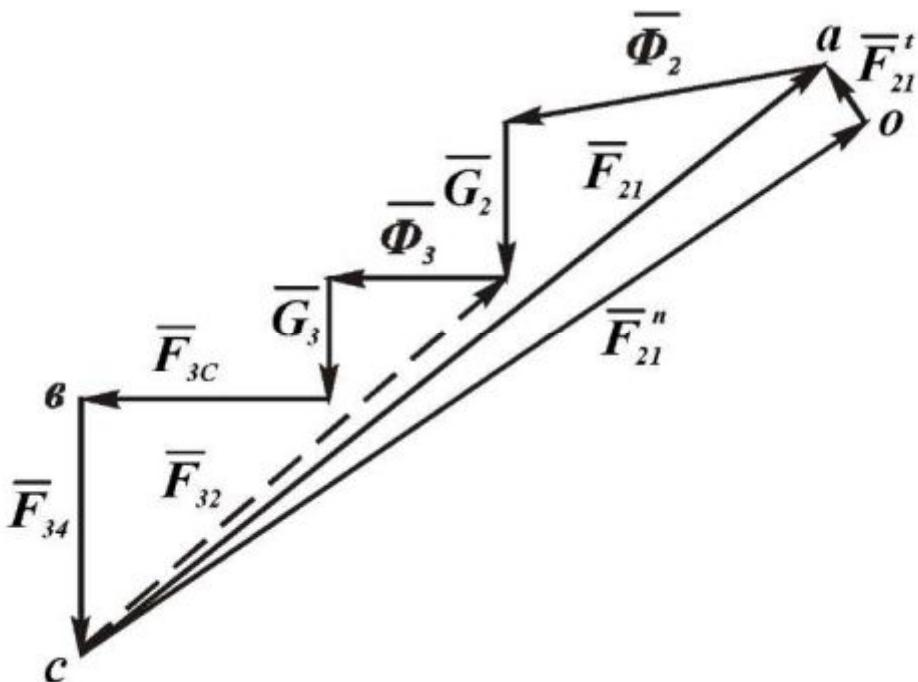
Рис. 2. План сил группы Ассупа 2-3 (ВВП),  $K_F = \dots$ , Н/мм
