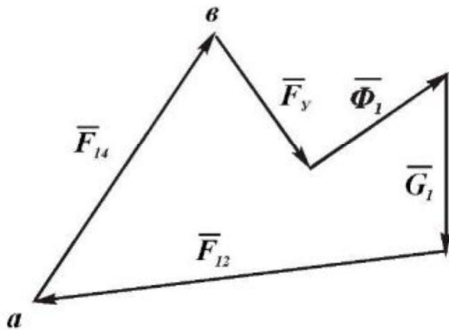
Рис. 11. План сил начального механизма,  $K_F = \dots$ , Н/мм
