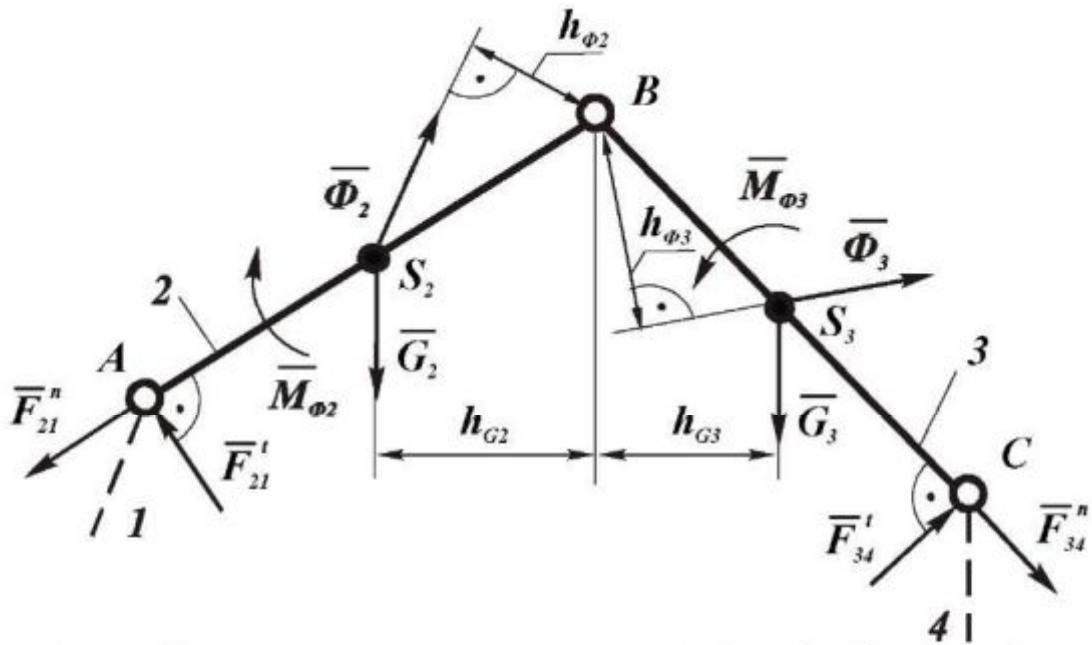
Рис. 3. Схема сил группы Accura 2-3 (BBB),  $K_l = \dots$ , м/мм
