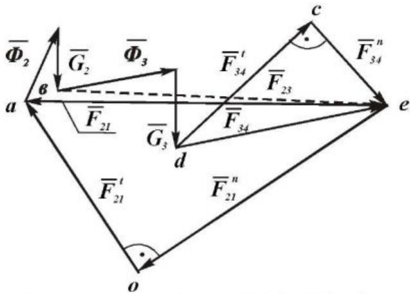
Рис. 4. План сил группы Ассура 2-3 (БББ),  $K_F = \dots$ , Н/мм
