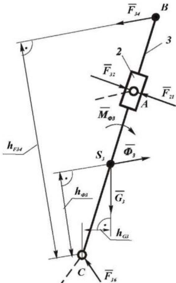
Рис. 5. Схема сил группы Ассура 2-3 (ВПВ),  $K_l = \dots$ , м/мм
