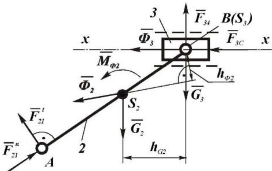
Рис. 1. Схема сил группы Ассура 2-3 (БВП),  $K_l = \dots$ , м/мм
