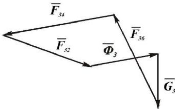
Рис. 6. План сил группы Ассура 2-3 (ВПВ),  $K_F = \dots$ , Н/мм
