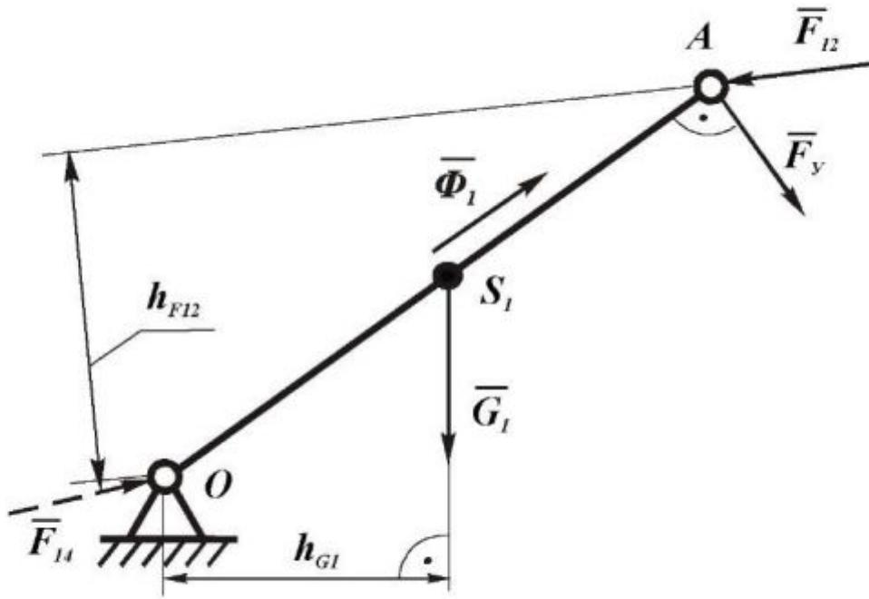
Рис. 10. Схема сил начального механизма,  $K_l = \dots$ , м/мм
